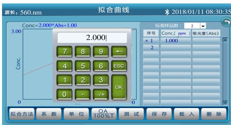
3、浓度值设定完成后，将参比液拉入光路，用户设定波长后，仪器将走到选定波段并处校空白；
